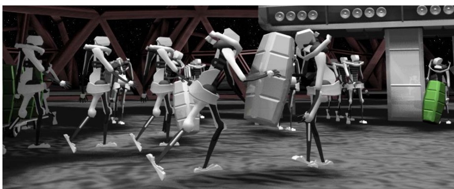
図4 月面活動高度情報化・シミュレーション技術。CADモデルと実情報を組み合わせて仮想空間において高速高精度シミュレーションを行い、行動のリアルタイム制御や行動計画に利用する。
